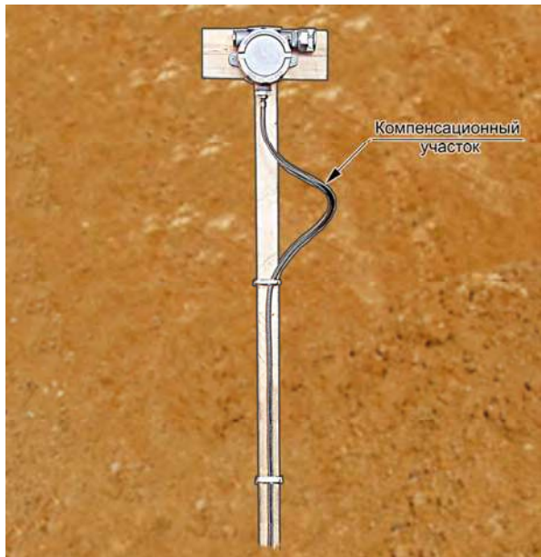
Рисунок 2.9 – Правильное положение головок типа «Г6», «Г6/1», «Г6/2», «Г7», «Г7/1», «Г7/2», «Г6М», «Г7М», «Г6Н», «Г7Н» с кабелем на основе гибкого рукава в оплетке на месте их установки
